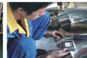
双相钢铁素体检测Ferrite Meter test
